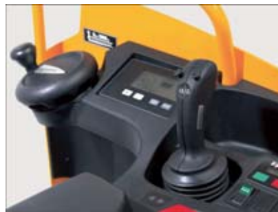
Bedienung aller Fahr- und Hubfunktionen mit dem Multifunktionshebel beim ESE 220/320
