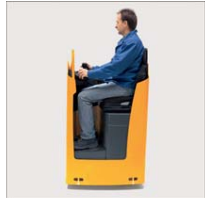
Komfortable Sitzposition mit höhenverstellbarem Bodenblech beim ESE 220/320
