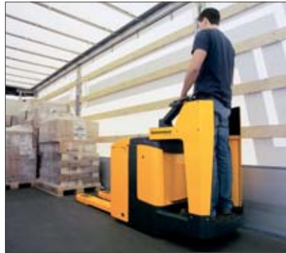
Geschützter Fahrerplatz durch feste Standplattform
