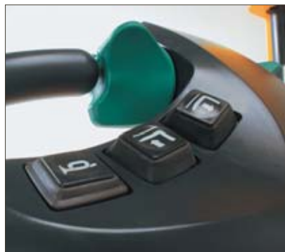
Taster für feinfühliges Heben und Senken, sowie Hupen
