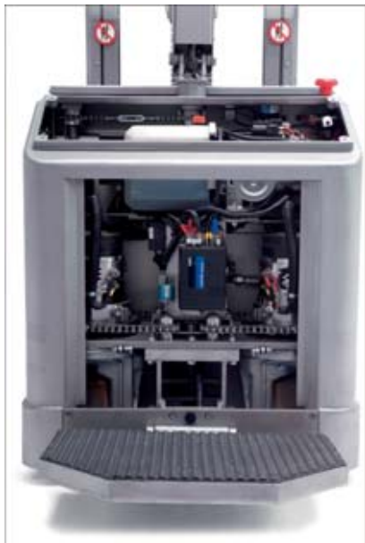
Optimaler Servicezugang zum Antriebsraum
