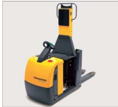
Kommissionieren aus der zweiten Regalebene mit hebbarer Standplattform
