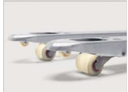
Abgerundete Gabelspitzen für leichten Einschub in die Palette
